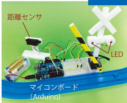
マイコンと距離センサ、サーボモーターを組み合わせて、電車が近づくと、自動的に遮断機がおりる踏切を作ろう。ホンモノの踏切みたいに作れるかな？
