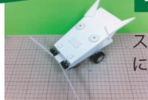
スイッチとモーターを組み合わせ、壁にぶつからずに走り続ける車を作ります。
