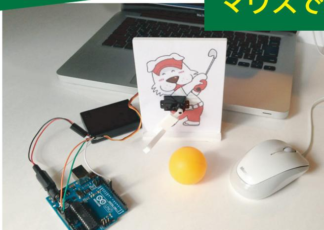
パソコンの画面上のブロックをマウスで動かすとそれに合わせてサーボモーターが動きます。ボールを打つロボットを作ってみよう！
